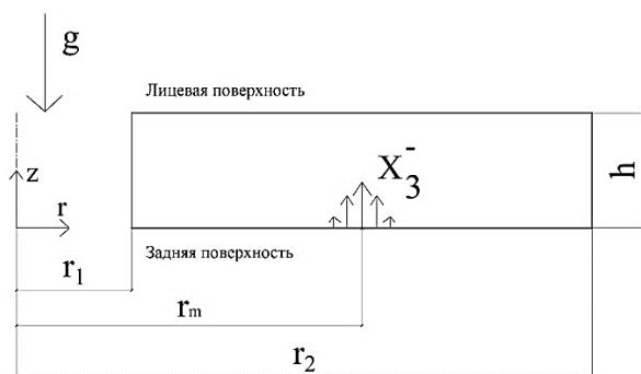
Рис. 1. Кольцевая пластина постоянной толщины. Расположена на локальной опоре, реакция которой заменена распределенной нагрузкой / Fig. 1. Circular plate of constant thickness. The plate is located on a local support, its reaction is modelled by a distributed load
